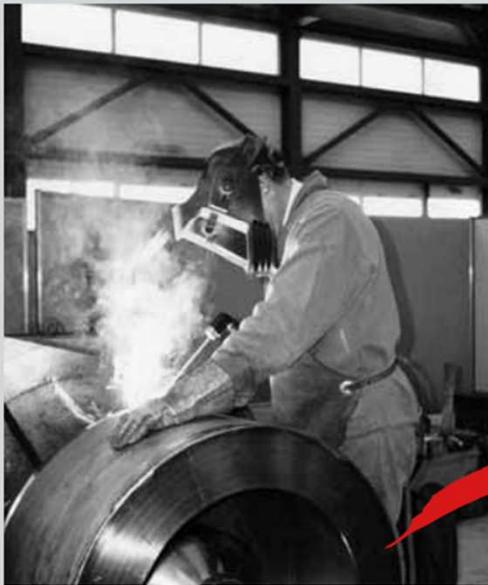
**Saldatura in gas protettivo**
