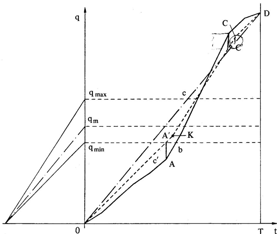
Fig. 3.13 - Determinazione del volume del serbatoio con generatore di potenzialità superiore alla richiesta media.
