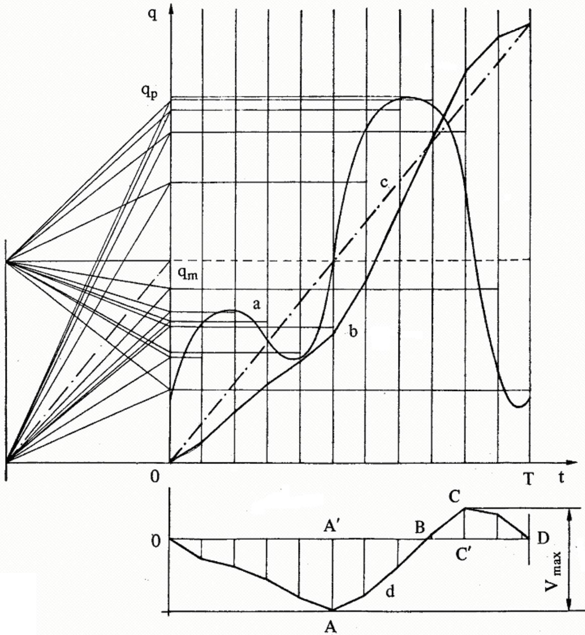
Fig. 3.12 - Determinazione del volume del serbatoio per completa disponibilità del servizio.
