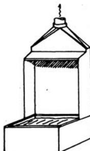
CAPPA DI ASPIRAZIONE SUL FIANCO POSTERIORE DI UNA VASCA CHE ESPANDE VAPORI O GAS
